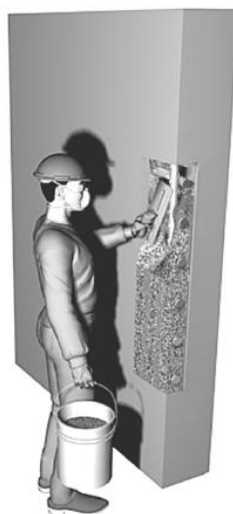
Figura 48 – Aplicação do material de reparação [35]
